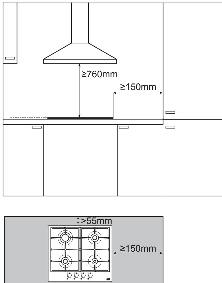
**FR Avertissement :** une bonne ventilation est nécessaire autour de l'appareil pour faciliter la dispersion de la chaleur et une faible consommation d'énergie. Un espace suffisant est nécessaire autour de l'appareil, comme indiqué dans les schémas ci-dessus. L'espacement entre la plaque de cuisson et tout placard ou extracteur au-dessus doit être au moins de 760 mm.
