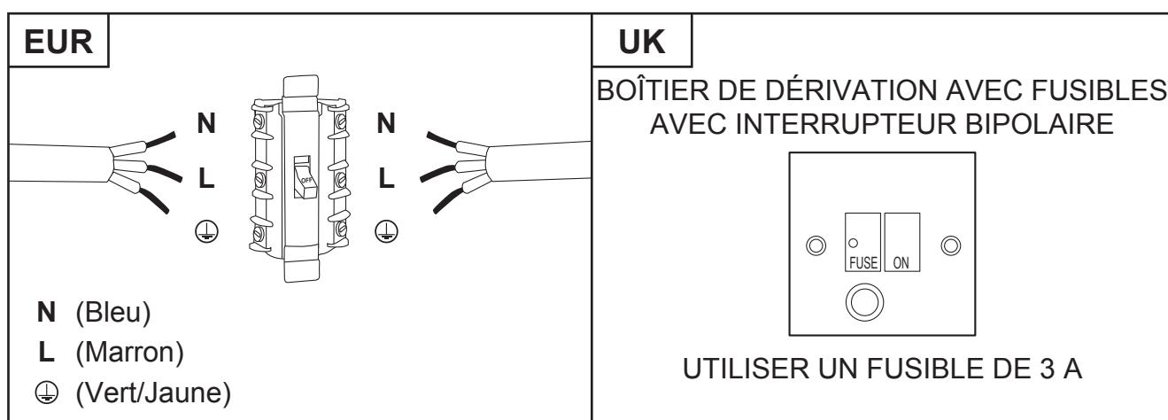
**Cet appareil nécessite un disjoncteur miniature de 3 A.**
