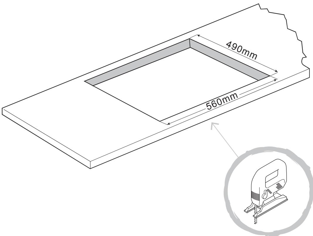
**EN** Découpez une ouverture dans le plan de travail à l'aide d'une scie sauteuse, comme indiqué. Le plan de travail doit être d'au moins 30 mm d'épaisseur et être fabriqué à partir d'un matériau résistant à la chaleur.
