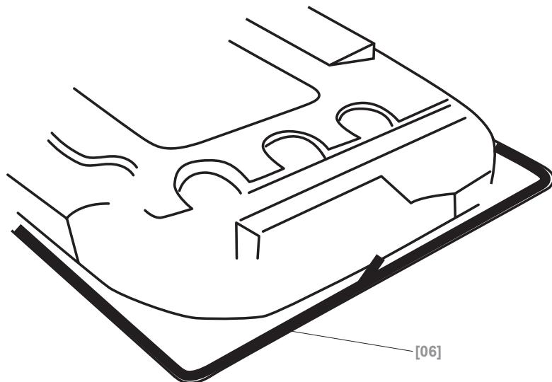
**FR** Étirez la garniture d'étanchéité fournie le long du rebord inférieur de la plaque de cuisson, en assurant le chevauchement des extrémités.
