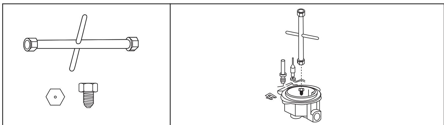
**Nota:** Se facilitan inyectores de gas adicionales para permitir la conversión del aparato para usarlo con distintos tipos de gas, incluidos el butano, el propano y el gas licuado del petróleo (GLP). Los datos sobre los inyectores adicionales y sus aplicaciones pueden encontrarse en la tabla de inyectores que figura más adelante en este manual. Estos inyectores deben sustituirse con una herramienta especializada y específica, no incluida.
